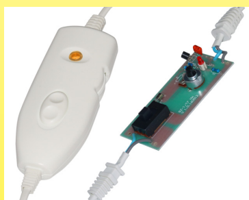
2019 Блок управления одеялом с непрерывным электронным управлением мощностью (коллекция Ultimheat)
