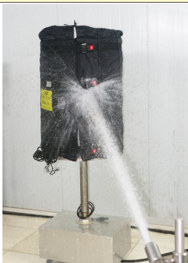
Испытание нагревателей рубашки на степень защиты IPx6
